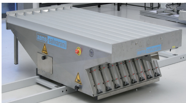
Slika 5. Sprej skener – uređaj za merenje horizontalne distribucije tečnosti
