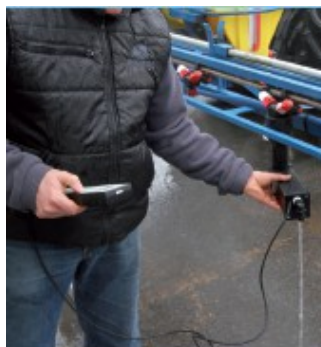
Slika 7. AAMS-Salvarani merač protoka pojedinačnih rasprskivača S001
