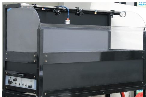
Slika 8. Demo jedinica – uređaj za demonstraciju i ispitivanje rada rasprskivača
