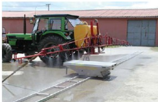
Slika 5. Sprej skener – uređaj za merenje horizontalne distribucije tečnosti
